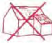
Rupture d'inclinaison des pentes
