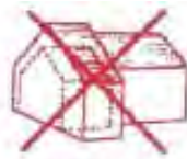
Pignons trop large mal proportionnés
